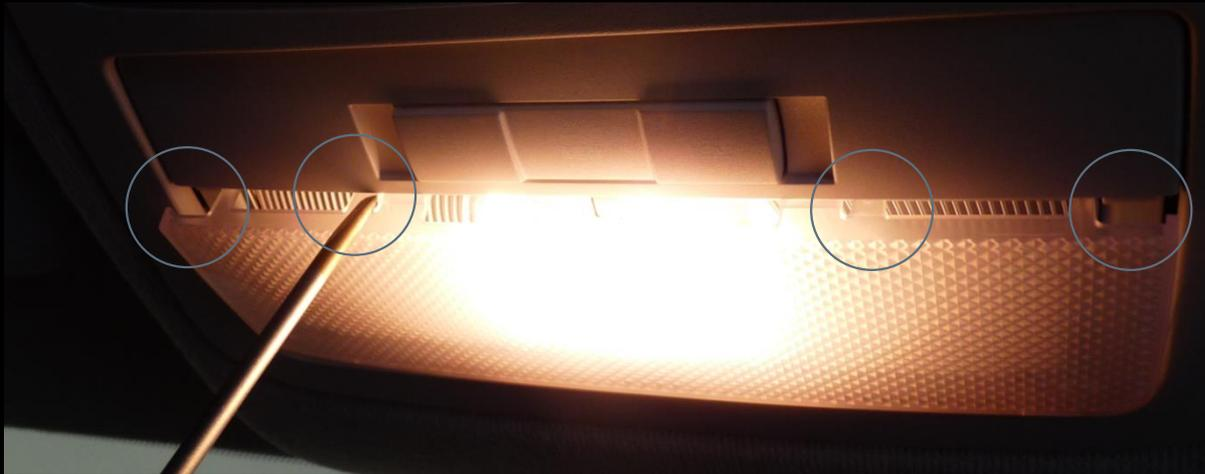
Schraubenzieher in die Lücke setzen. Leicht hebeln und dann zur bis zu nächsten Clip überziehen. Gewalt ist nicht notwendig.
